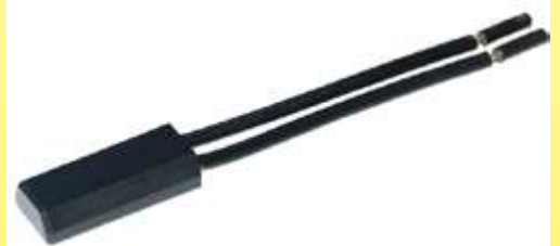
2019 Abknickbarer Temperaturbegrenzer für Heiztransformatoren, abgeleitet vom Modell 7AM von Texas Instruments aus dem Jahr 1966, verwendbar bei 230V, in wasserdichtem Kunststoffgehäuse. Temperaturbereich von 5 bis 8°C. Typ V7AM (Ultimheat-Sammlung).
