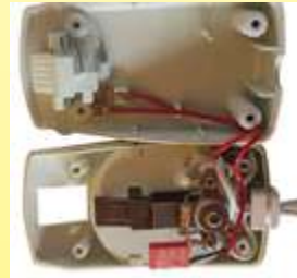
1995: Eine amerikanische Leistungsmesser-Heizdecke, ähnlich der, die mehr als 50 Jahre zuvor von Cook 1942 entwickelt wurde. Außenansicht und Blick auf das innere Bimetall hat einen langsamen Unterbrecher mit vorweggenommenem Widerstand. Die einzige bemerkenswerte Entwicklung dieses Modells ist der Einbau eines Rauschfilters. (Ultimheat-Sammlung)
