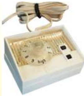
Ca. 1970. Leistungseinstellung von GEC (General Electric, England) an einer englischen Heizdecke. Der zu erwartende Widerstand ist deutlich über dem Bimetall und dem langsamen Unterbrecher zu erkennen. (Ultimheat-Sammlung).
