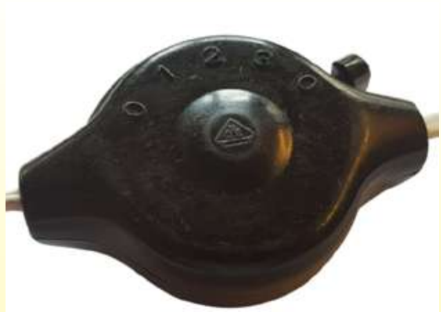
Ca. 1955. 5-Stellungs-Drehschalter ähnlich dem Modell Cuche, jedoch mit Schnappschalter (deutsche Herstellung LW Lohmann und Welschehold GmbH & Co. in Meinerzhagen). (Ultimheat-Sammlung)
