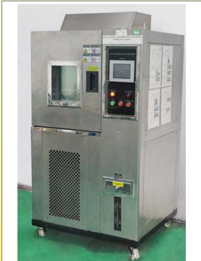
Klimakammer, mit Temperatureinstellbereich von -90 bis +150^{\circ}C , Einstellbereich der relativen Luftfeuchtigkeit 1 bis 100%
