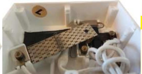
Ca. 1970. Leistungseinstellung von GEC (General Electric, England) an einer englischen Heizdecke. Der zu erwartende Widerstand ist deutlich über dem Bimetall und dem langsamen Unterbrecher zu erkennen. (Ultimheat-Sammlung).
