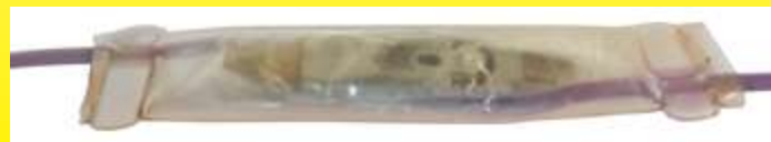
Temperaturbegrenzer für Heizdecken mit langsamer Unterbrechung, der in Verbindung mit einem englischen Leistungsregelungssystem der Firma GEC (General Electric Company) verwendet wird. Er ist mit einer wasserdichten PVC-Hülle überzogen, die mit den Drähten verschweißt ist. Ca. 1970 (Ultimheat-Sammlung)
