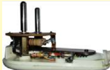
Ca. 1972. Schaltkasten der Firma Jidé in Limoges unter der Marke Jidéstat. Das erfolgreichste aller Systeme. Es ist sehr klein, einstellbar und in den Stecker integriert. Dies ist das einzige Modell mit einem Schnappmagnetkontakt. Es wurde erst in der heutigen Zeit von elektromechanischen Systemen überholt. (Ultimheat-Sammlung)
