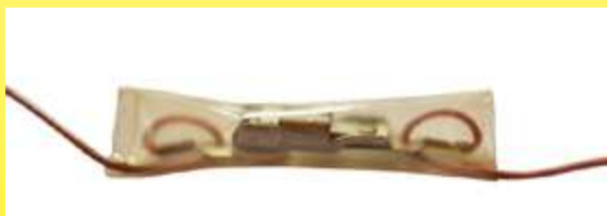
Temperaturbegrenzer für Calor-Heizmatten mit langsamer Unterbrechung, geeicht auf 80°C (ca. 1960). Man beachte die wasserdichte PVC-Hülle, die auf die Drähte geschweißt ist, und die Schleife, die durch die elektrischen Leiter gebildet wird, die durch ein Loch in jeder Klemme geführt werden - dies dient dazu, Zugspannungen auf den Draht zu vermeiden (Ultimheat-Sammlung).
