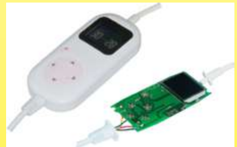
2019 Regelgerät für temperaturgeregelte Heizdecken mit Digitalanzeige über einen in der Heizfläche eingebauten Thermistorfühler (Ultimheat-Sammlung)
