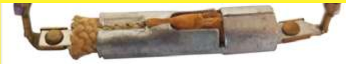
Temperaturbegrenzer für Heizdecken mit langsamer Unterbrechung, der in Verbindung mit einem englischen Leistungsregelungssystem der Firma GEC (General Electric Company) verwendet wird. Er ist mit einer wasserdichten PVC-Hülle überzogen, die mit den Drähten verschweißt ist. Ca. 1970 (Ultimheat-Sammlung)
