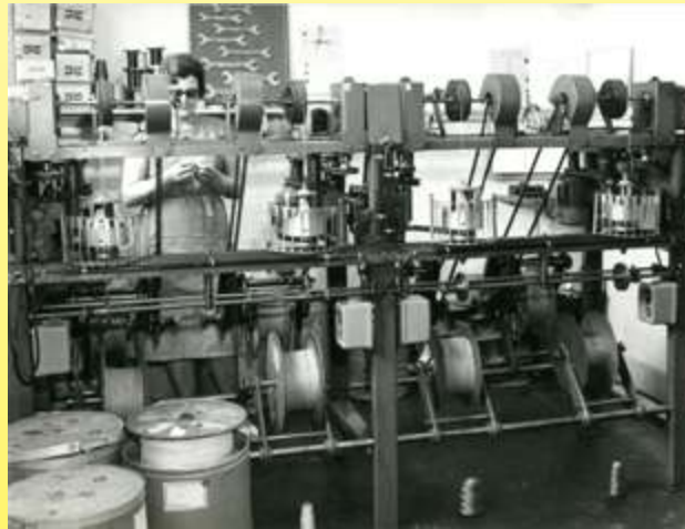
Ca. 1960. Guipage-Werkstatt für Heizschnüre für Heizdecken (Ultimheat Museum)
