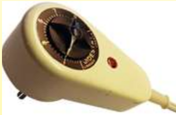
Ca. 1972. Schaltkasten der Firma Jidé in Limoges unter der Marke Jidéstat. Das erfolgreichste aller Systeme. Es ist sehr klein, einstellbar und in den Stecker integriert. Dies ist das einzige Modell mit einem Schnappmagnetkontakt. Es wurde erst in der heutigen Zeit von elektromechanischen Systemen überholt. (Ultimheat-Sammlung)
