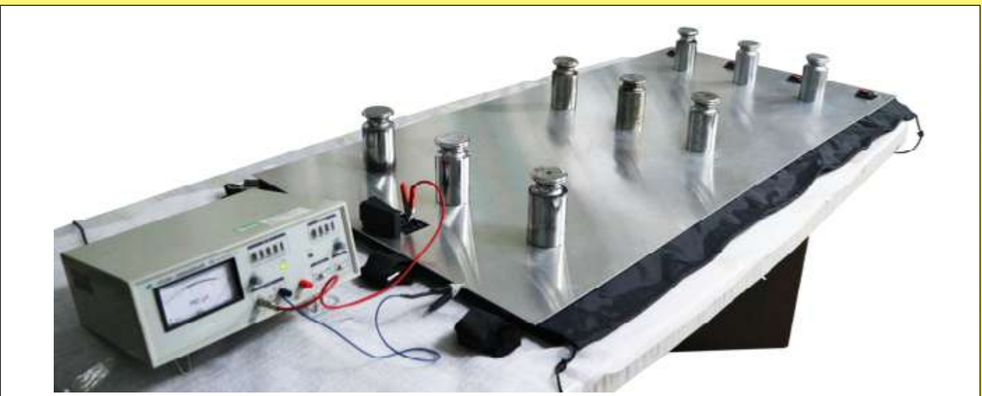
Gerät zur Messung des Isolationswiderstandes. Die gemessenen Werte sind immer größer als 0,1Gohm.
