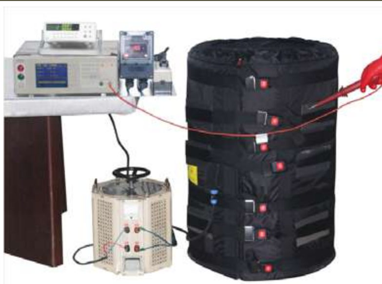
Messgeräte für den Gesamtableitstrom im heißen Zustand
