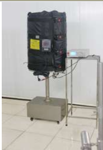
Messung des Isolationswiderstands nach IPx6-Tests
